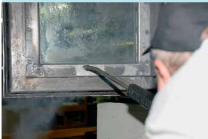
Minimaler Wasserverbrauch – große Wirkung: Gut zu sehen sind die von Bruno Mazurek bereits gereinigten und die dazwischenliegende ungereinigte Fläche. Der 20 l fassende Wassertank reicht – je nach Verschmutzungsgrad – etwa für eine Stunde Arbeit.
