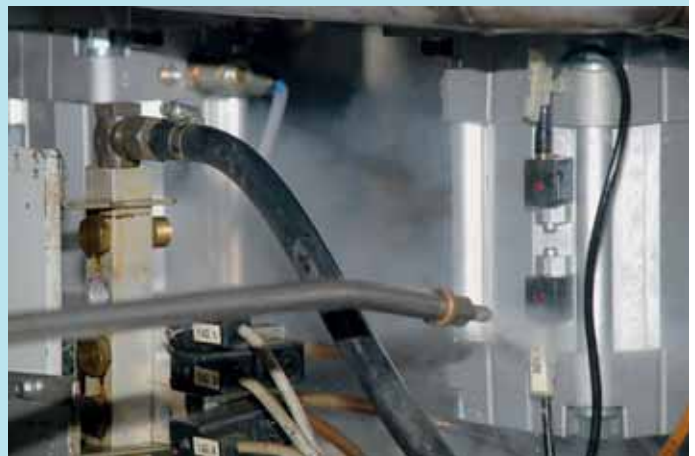
Ob Sensoren, Zellen oder Leitungen – bei der Reinigung mit Dampf braucht man keine Angst zu haben, etwas zu beschädigen. Andersorts wurde sogar schon ein Fließband bei laufender Produktion störungsfrei gereinigt.
