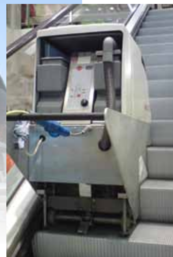
Mit einer ROTOMAC Alta 20 reinigen wir Rolltreppen auf hochprofessionelle Art
